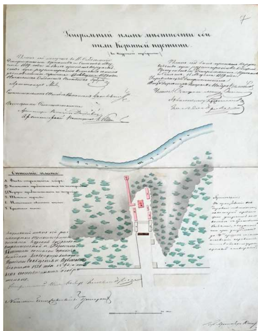
Генеральный план местности обители Коренной пустыни (в Курской губернии). На плане показаны: А. Вновь строящийся собор; В. Колокольня, предназначенная к постройке; С-Е. Корпуса, предполагаемые к постройке; D. Теплая церковь; Е. Источник явленной иконы; F. Братские кельи. Источник: РГИА. Ф. 218. Оп. 3. Д. 1792. Л. 7.
