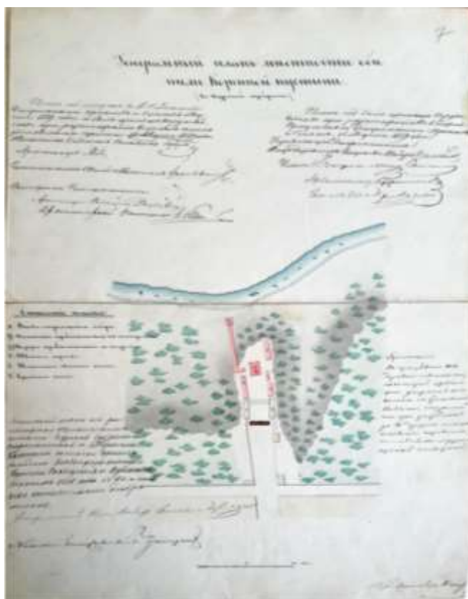
Генеральный план местности обители Коренной пустыни (в Курской губернии). На плане показаны: А. Вновь строящийся собор; В. Колокольня, предназначенная к постройке; С-Е. Корпуса, предполагаемые к постройке; D. Теплая церковь; Е. Источник явленной иконы; F. Братские кельи.
